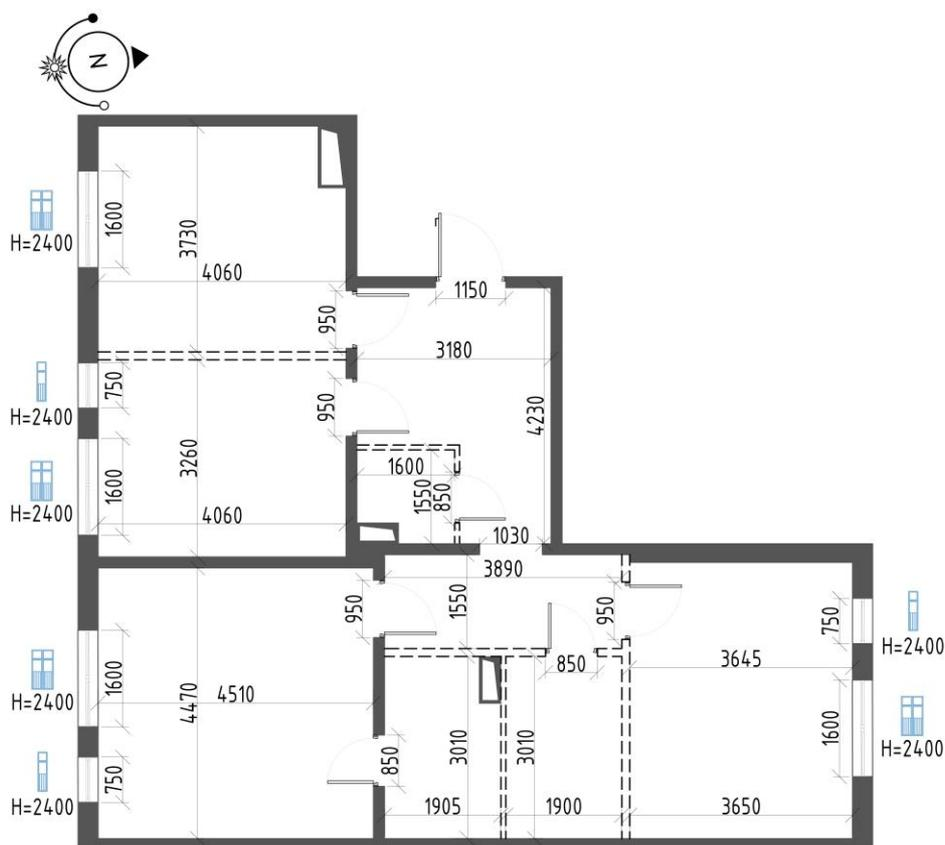
Внутриквартирные перегородки, изображенные пунктирными линиями, возводятся Застройщиком на высоту одного блока перегородочного материала
