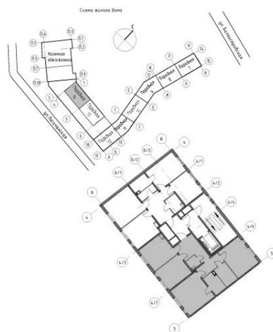
Внутриквартирные перегородки, изображенные пунктирными линиями, возводятся Застройщиком на высоту одного блока перегородочного материала
